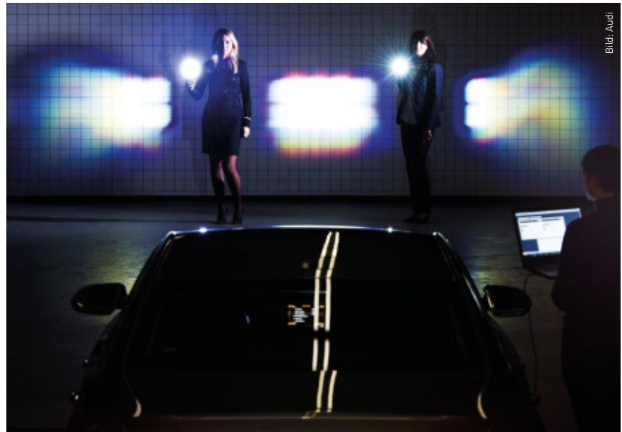
Blendfreies Fernlicht: Detektiert die Kamera andere Verkehrsteilnehmer, werden diese einfach aus der Fernlichtverteilung ausgespart und somit nicht geblendet.
