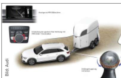
Der Audi A4 allroad erkennt den Knickwinkel über den in der Anhängerkupplung integrierten Sensor.
