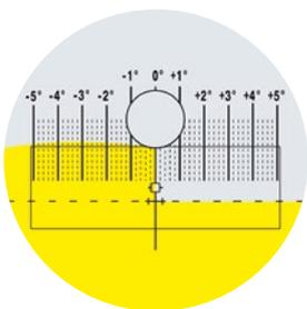
**Prüfschirm** mit vertikaler Skalierung zur Prüfung von Scheinwerfer-Systemen mit blendfreiem Fernlicht
