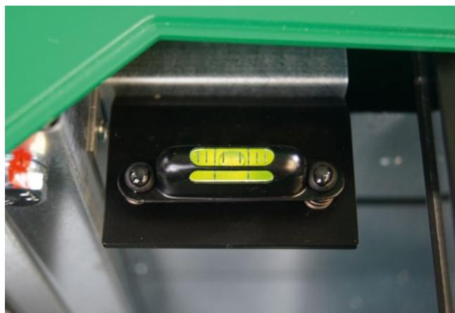
**Wasserwaage.** An der Exzenterachse können von der Libelle angezeigte Bodenunebenheiten bzw. Neigungen ausgeglichen werden.
