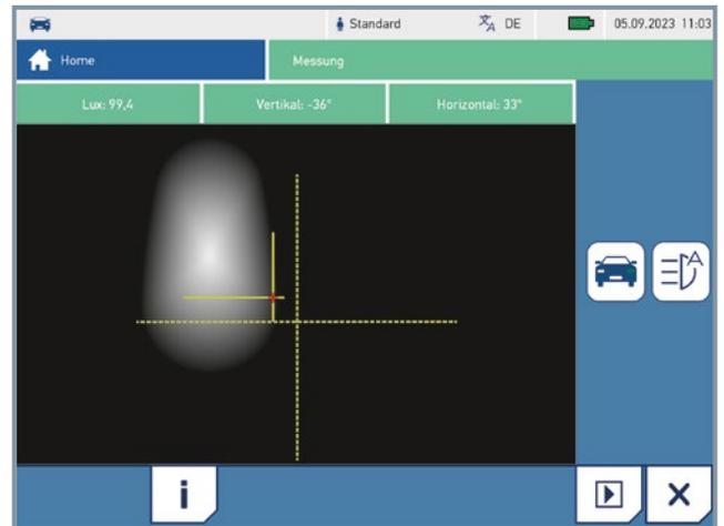
Beispiel Audi Q8: Über die Master LED wird eine spezielle Lichtverteilung generiert. Die horizontale Position der „inneren vertikalen Hell-Dunkel-Grenze“ der Lichtverteilung ist das Maß der Dinge. Deren Abstand von der Y-Achse des Koordinatensystems wird in Winkelminuten angegeben. Dieser Wert wird mit Hilfe eines Diagnosetesters im betreffenden Steuergerät abgespeichert.
