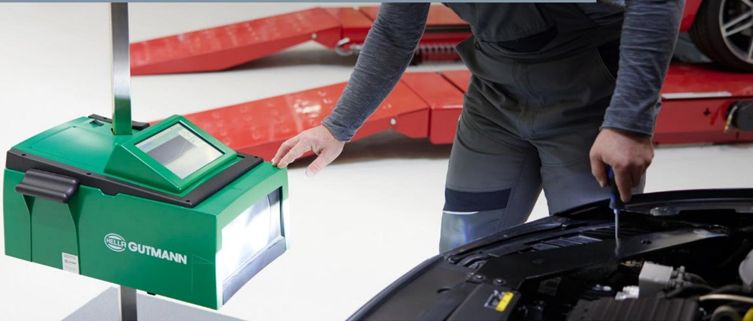
Ein Bild sagt bekanntlich mehr als tausend Worte. Gleichzeitig mit dem Drehen der Verstellschrauben in vorgegebener Pfeilrichtung verschiebt sich die abgebildete Lichtverteilung bis hin zum erfolgreichen Match mit den Hilfs- und Toleranzlinien.
