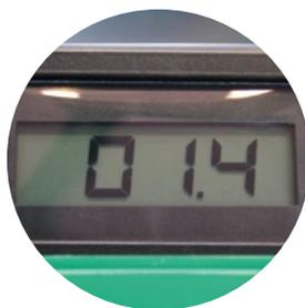
**Digitales Luxmeter.** Mit ihm lassen sich der Blendwert des Abblendlichts und die Beleuchtungsstärke des Fernlichts ermitteln.
