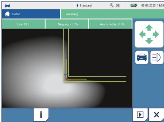
Beispiel VW: Bei Fahrzeugen, die mit DLA (Dynamic Light Assist) ausgestattet sind, zeigt sich die oben dargestellte Lichtcharakteristik. Die korrekte Justierung wird mechanisch über die entsprechende Einstellschraube vorgenommen. Die Grundeinstellung wird mit Hilfe des Diagnosegeräts komplettiert.
